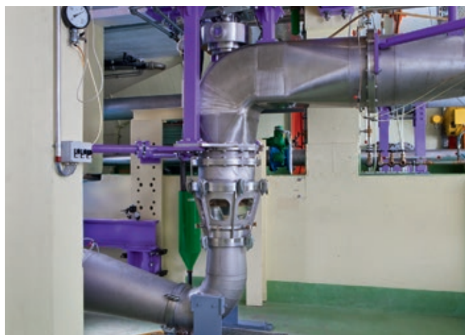
Turbine Diagonale Saxo sur le stand d'essais MhyLab
